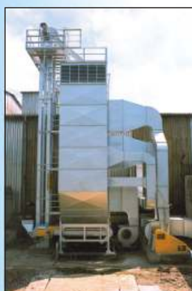
Sesypné sušárny zrnin
